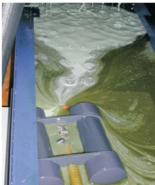
Absaugschwimmer entfernt Öl von Emulsion
